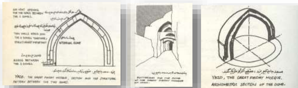
تصویر ۹- مسجد جامع کبیر یزد مقطع و ترکیب ساختمانهای گنبد دو پوسته (توسلی، ۱۳۵۳: ۸۱)
