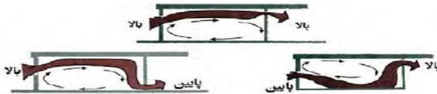
شکل 3- حالات مختلف بازشو و تغییر در نوع سیر کولاسیون هوا (اخوی زادگان، 1392)
