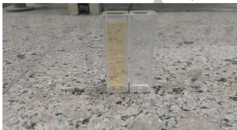
شکل ۴: سل‌های مورد استفاده در دستگاه پتانسیواستات، سمت راست آب مقطر و سمت چپ محلول گرفته شده از محیط الکترولیت
