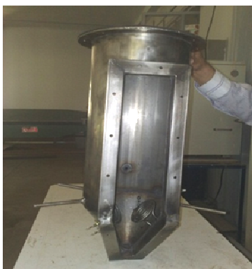
شکل ۱ - راکتور STR تولید بیو دیزل موجود در کارگاه
