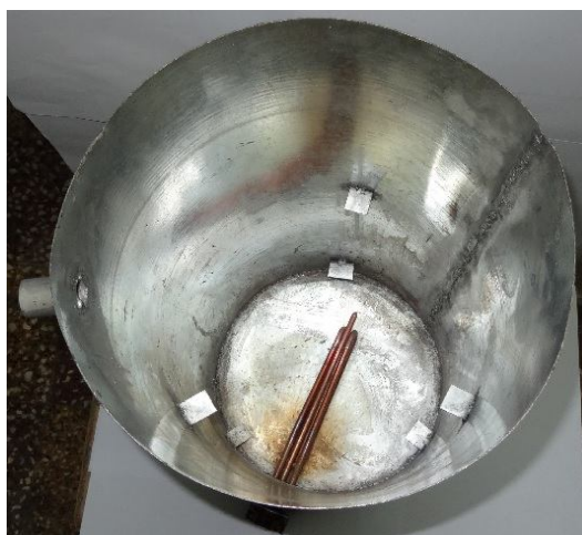
شکل ۲- نحوه قرارگیری گرمکن الکتریکی
