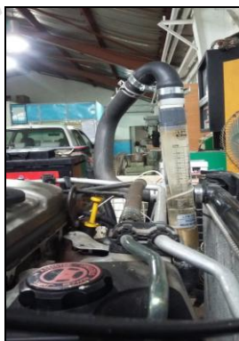
شکل (۳) محل و چگونگی نصب روتامتر در سیستم آزمایشگاهی
