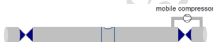
شکل (۴): یک نمونه خط لوله با گاز محبوس شده و انتقال گاز آن توسط یک موبایل کمپرسور
