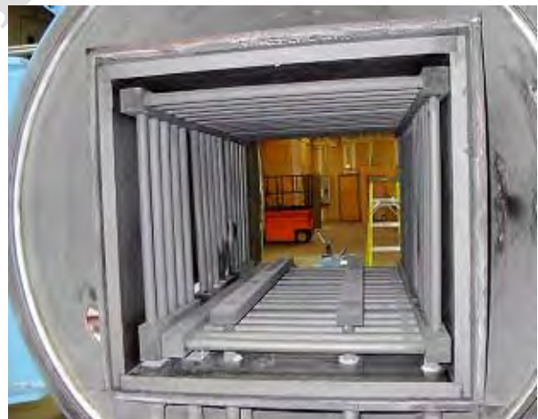
شکل ۱. کوره نوع عایق با المان حرارتی گرافیتی میله‌ای
