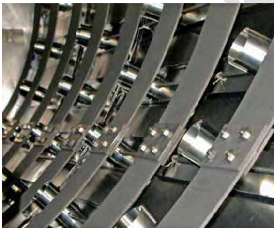
شکل ۲. المان حرارتی گرافیتی سبک و انحنادار
