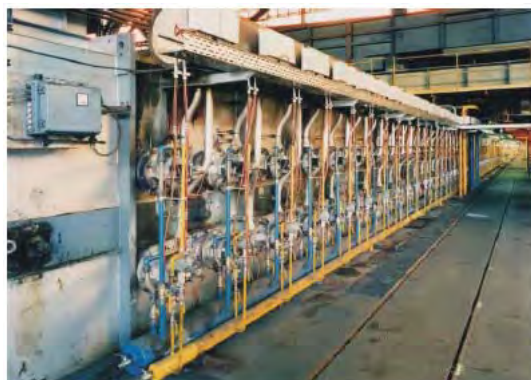
شکل ۱۴. نصب لوله های تابشی سرامیکی در یک خط تولید نوار فلزی سیلیکونی
