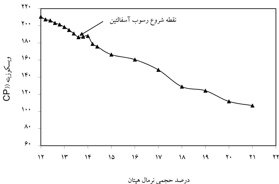
شکل ۳- تعیین نقطه شروع نمونه نفت خام مرده به همراه دودسیل بنزن سولفونیک اسید شاخه دار با غلظت ۱۰۰۰ ppm
