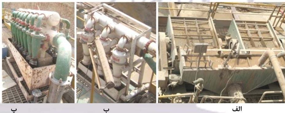
شکل ۱: نمایی از دستگاه‌ها الف-الک لرزان ب-ماسه زدا پ-شن زدا
