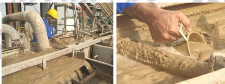
شکل ۳: نحوه‌ی نمونه‌گیری از حوضچه‌ی الک لرزان
