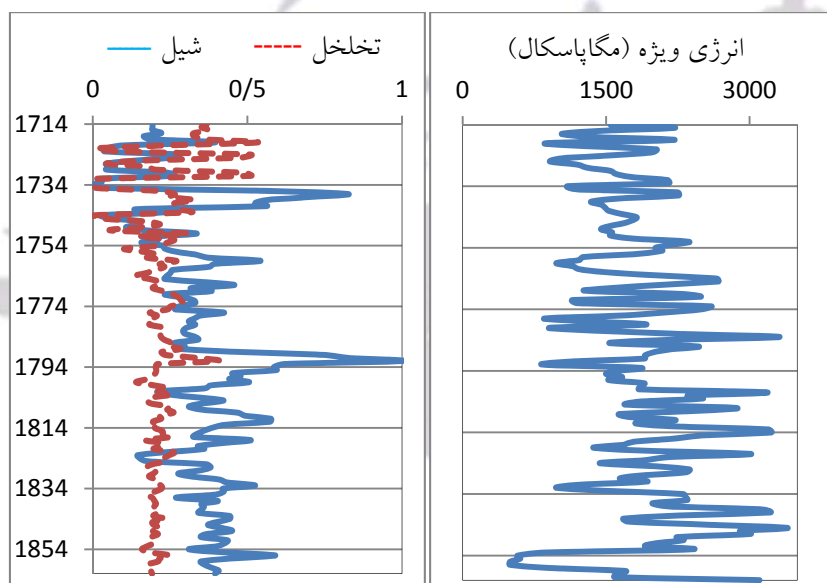
نمودار (۳): نمودار انرژی ویژه (راست) و نمودار درصد شیل و تخلخل (چپ) در برابر عمق برای مت‌های شماره‌ی ۶ از چاه اکتشافی
