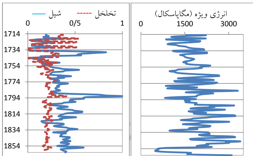
نمودار (۹): نمودار انرژی ویژه (راست) و نمودار درصد شیل و تخلخل (چپ) در برابر عمق برای مته‌ی شماره‌ی ۶ از چاه ۲۸
