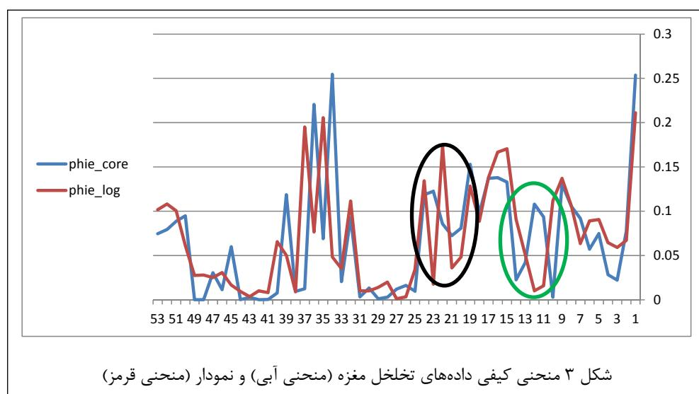
اثرات منفی ریزش شدید دیواره روی قرائت ابزار تخلخلی نوترون روی این شکل (منحنی سیاه) نیز مشخص است. چنانچه دیده می‌شود، روند نرمال نمودار در برخی حد فواصل به هم ریخته هست. همچنین اثر تفاوت جزئی عمق نیز در بخشی از آن مشهود است (منحنی سبز).
