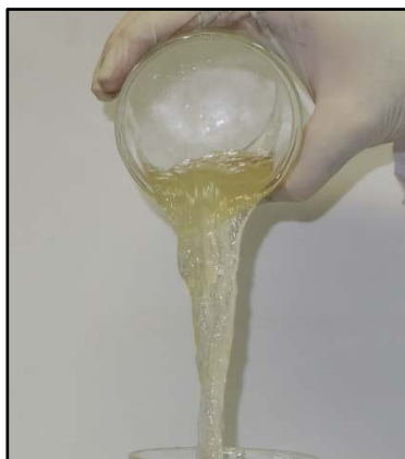
تصویر ۱. ژل DiVES-350 در حضور افزایه‌های بازدارنده خوردگی، کنترل کننده آهن و زداینده هیدروژن سولفید.
