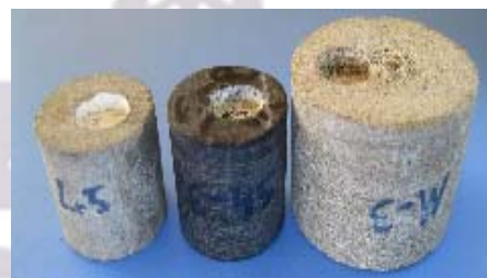
شکل ۱. سنگ های مورد آزمایش، از چپ به راست سنگ آهک، شیل، ماسه سنگ
