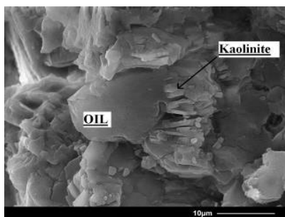
شکل ۵: تصویر SEM یک نمونه سنگ مخزن با کانی‌های کائولیت پوشش داده شده با آب.
