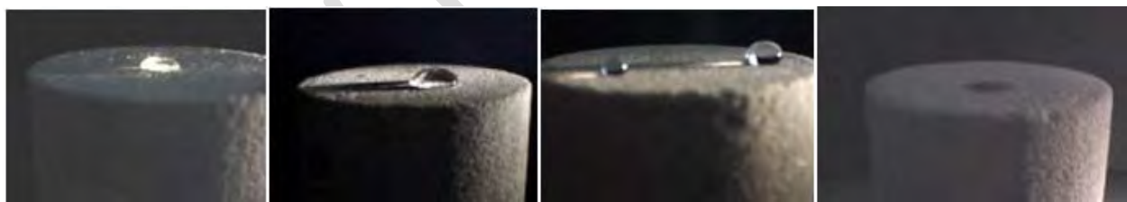
(a) آب (بدون درمان شیمیایی) (b) آب با ۲ درصد FC722 و \theta=125 (c) آب با 0/18 درصد FC722 و \theta=120 (d) نفت با ۲ درصد FC722 و \theta=60
