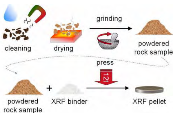
شکل (۳): تصویری از مراحل آماده‌سازی و دستگاه قابل حمل ED-XRF (تصویر برگرفته از مقاله‌ی آلبرت مارسالا ۲۰۱۱ [۵] است)
