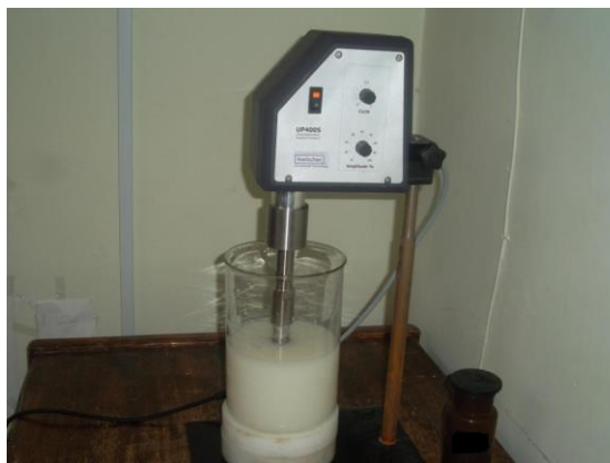
شکل (۲): نمایی از دستگاه امواج فراصوت مورد استفاده برای پایداری نانو سیال.
