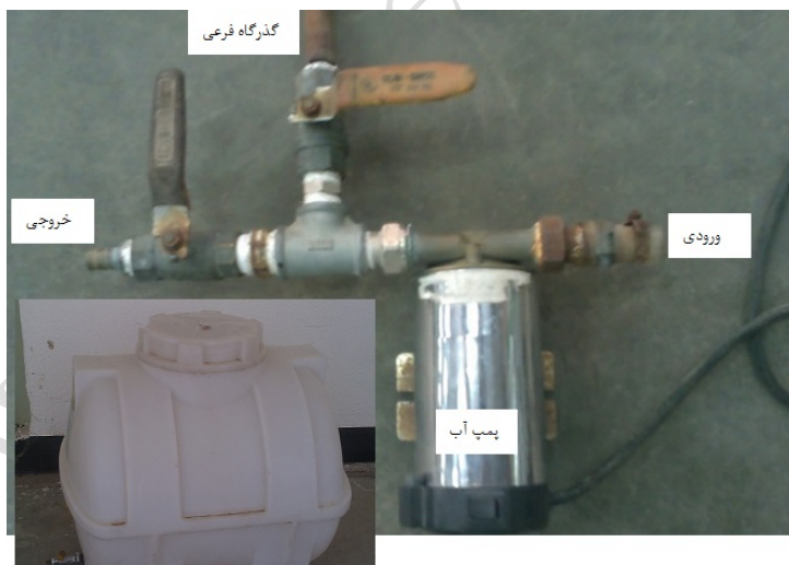
شکل ۱: مخزن و پمپ آب مورد استفاده
