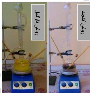
شکل ۲- راکتور تولید بیودیزل به روش استریفیکاسیون
