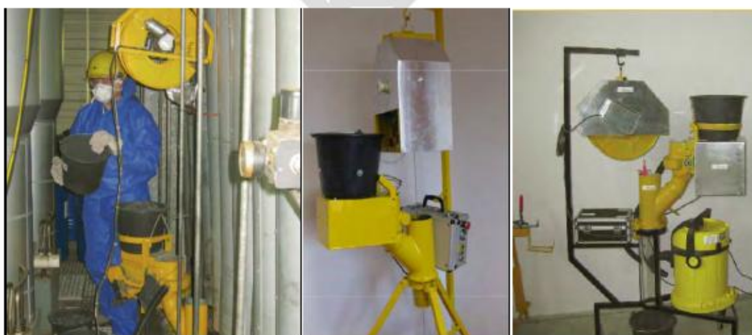
تصویر شماره ۳۴: آرایش قنرها ی بکار رفته روش Unidense و نحوه بارگذاری [43], [44].
