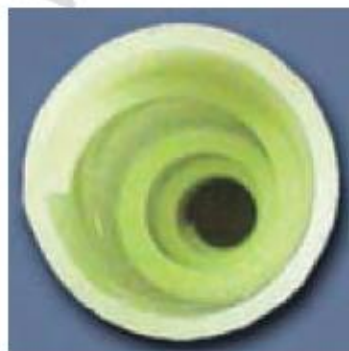
تصویر شماره ۲۲: نمایی از درون لوله ماریچی روش Spiraload [30]
