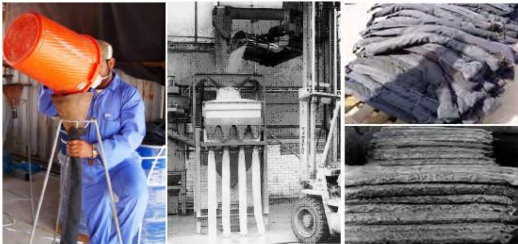
تصویر شماره ۱۳: جوراب‌های پر شده از کاتالیست در جوراب‌های پلی‌اتیلنی و برزنتی (راست) اجرای عملیات جوراب زنی با استفاده از قیف [4] (وسط) اجرای عملیات جوراب زنی توسط نفر (چپ)
