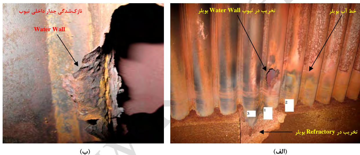
شکل ۱- (الف) تخریب به وجود آمده در تیوب Water Wall بویلر A و (ب) نازک‌شدگی جدار تیوب Water Wall ناشی از خوردگی داخلی
