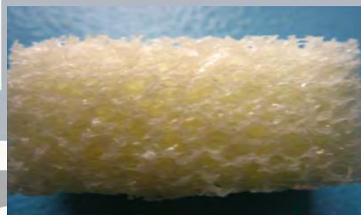
شکل شماره ۸- نمونه‌ای از داربست تولیدی با پلی یورتان و نانو هیدروکسی آپاتیت [۴۲]
