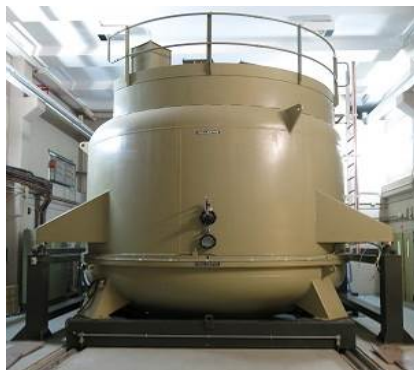
شکل (۱) تصویر محفظه لایه نشانی تلسکوپ WHT، عکس از نگارنده
