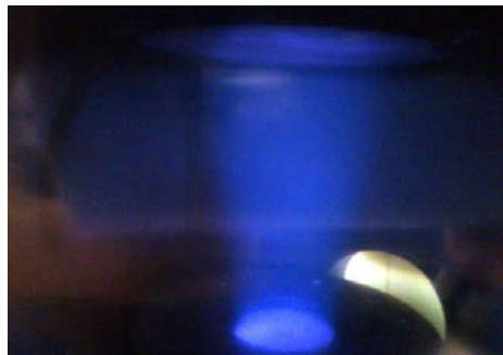
شکل ۴: پرتوی یون استخراج شده از چشمه یون بسامد رادیویی.
