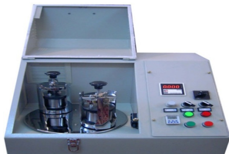
شکل ۲. آسیاب سیاره‌ای مورد استفاده برای اختلاط پودرهای عنصری و آلیاژسازی مکانیکی.
