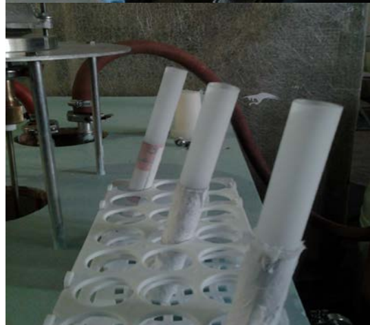
شکل 3: آزمایش عایق‌های چندلایه تشعشعی با نیتروژن مایع
