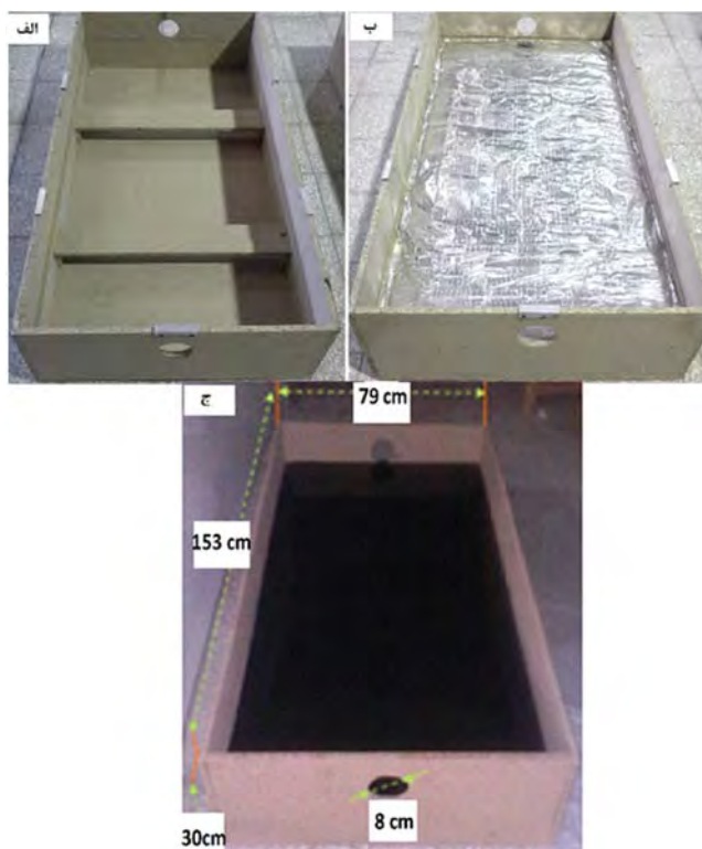
شکل ۱: اجزای مختلف هواگرمکن: (الف): بدنه چوبی هواگرمکن. (ب): عایق بندی پشت صفحه جاذب. (ج): نمای داخلی هواگرمکن با رنگ آمیزی صفحه جاذب.
