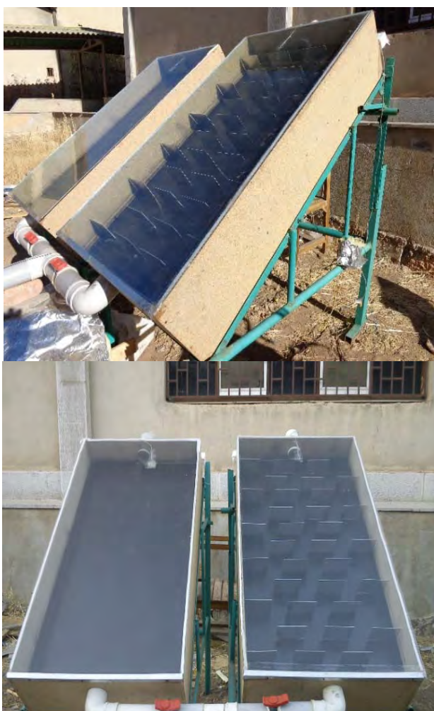
شکل ۲: دستگاه هواگرمکن خورشیدی از دو نمای مختلف: سمت راست هواگرمکن با موانع، سمت چپ هواگرمکن بدون موانع.
