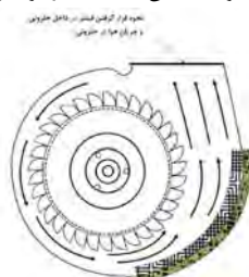
شکل (۴): حلزونی هود و نحوه قرار گرفتن فیلتر در آن
