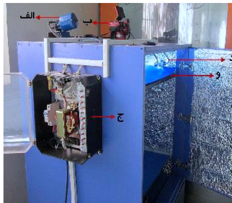
شکل ۱: اتاقک عکس‌برداری. الف) موتور، جهت تغییر ارتفاع صفحه‌ی پس‌زمینه. ب) دوربین که بر روی پایه‌ی اتاقک نصب‌شده است. ج) تابلوی کنترل روشنایی و لامپ‌های LED و راه‌اندازی موتور بالا‌برنده. د) لامپ LED به همراه پایه. و) صفحه‌ی پس‌زمینه.
