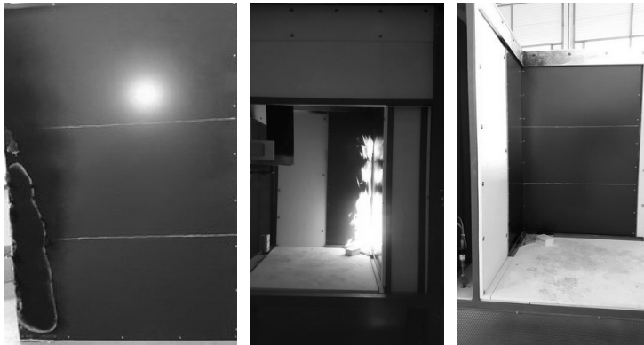
شکل ۶- ورق کامپوزیت آلومینیوم با کد ACS-9، به ترتیب از راست: قبل، حین آزمون SBI و پس از آن
