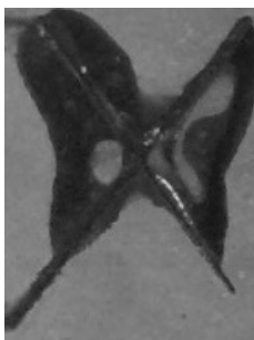
شکل ۱- پوشش اپوکسی به ضخامت ۶۰ میکرون تست مه‌نمکی بعد از ۱۲۶ ساعت
