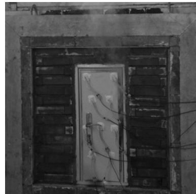
شکل ۳- خروج آتش از سطح غیر در معرض و شکست معیار یکپارچگی (دقیقه ۴)
