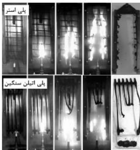
شکل ۳: نحوه سوختن ژئوگریدهای پلی استر و پلی اتیلن سنگین در آزمایش آفرورش شعله ۲۰ ثانیه بر اساس استاندارد ملی ایران ۴-۲۰۱۷۲۷۱ [۲۰]
