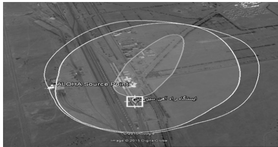
شکل ۵- همپوشانی شعاع‌های انفجار واگن‌های گازوئیل متوقف متأثر از انفجار مخزن متوقف
