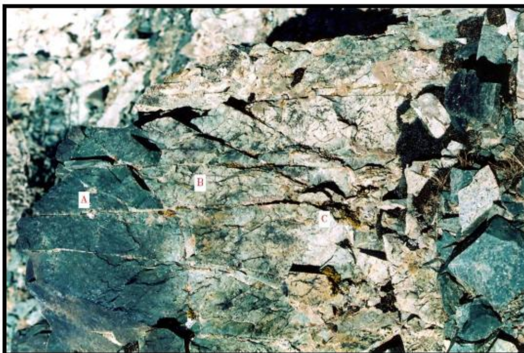
شکل ۱۱- وضعیت تبدیل و تغییر مینرالوژی از کوارتز-آلبیت متاسوماتیت (C) به زون واسطه (B) و سنگ میزبان (A)، B - زون واسطه با غلبه شدن آلبیت - کوارتز متاسوماتیت بر کوارتز متاسوماتیت واسطه، و A - زون کوارتز متاسوماتیت واسطه که در معرض جایگزینی با رخساره B است
