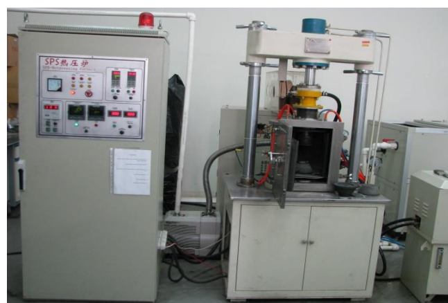
شکل ۲- تصویر دستگاه تفجوشی با جرقه پلاسما (SPS) استفاده شده در این پژوهش ( پژوهشگاه مواد و انرژی، کرج، ایران).
