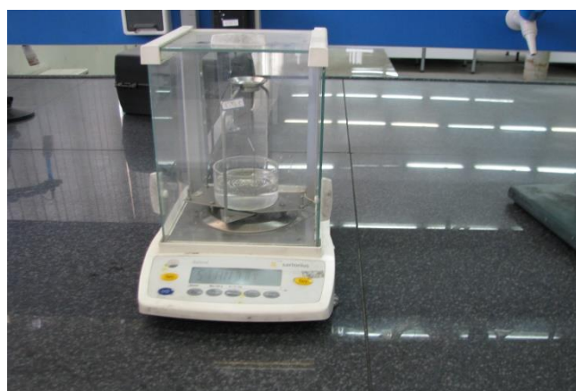
شکل ۳- ترازوی ارشمیدوس استفاده شده در این پژوهش (پژوهشگاه مواد و انرژی، کرج، ایران).
