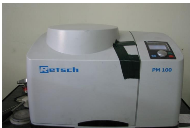
شکل ۱- دستگاه آسیابکاری ساخت شرکت Retsch آلمان استفاده شده در این پژوهش ( پژوهشگاه مواد و انرژی، کرج، ایران).
