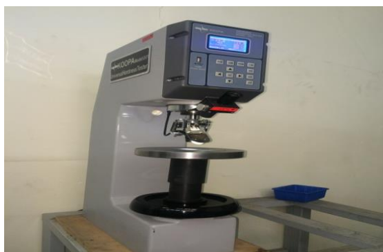
شکل (۳): دستگاه سختی سنجی استفاده شده در پژوهش (پژوهشگاه مواد و انرژی، کرج، ایران)
