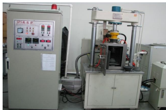
شکل (۲): تصویر دستگاه تفجوشی با جرقه پلاسما (SPS) استفاده شده در پژوهش (پژوهشگاه مواد و انرژی، کرج، ایران).
