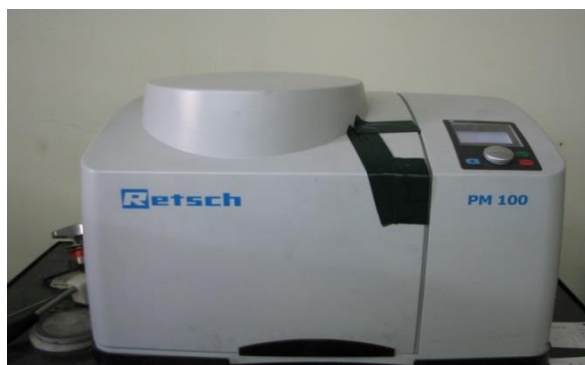
شکل (۱): دستگاه آسیابکاری ساخت شرکت Retsch آلمان استفاده شده در این پژوهش (پژوهشگاه مواد و انرژی، کرج، ایران)
