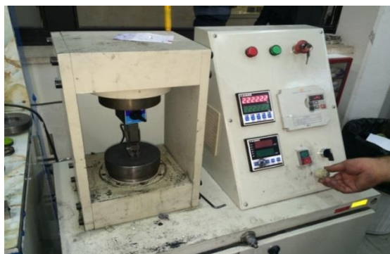
شکل (۴): دستگاه اندازه گیری استحکام سه نقطه‌ای استفاده شده در پژوهش (پژوهشگاه مواد و انرژی، کرج، ایران)
