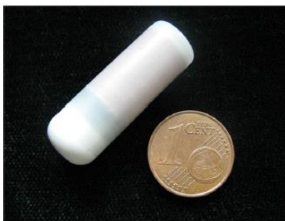
شکل ۴- نمای کامل بیرونی یک کپسول کنترل از راه دور (Xitian Pi a,c,2009:163)
