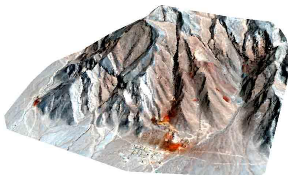
شکل ۵- تصویر سه بعدی که با استفاده از زوج استریو تصویر GeoEye در RGB تهیه شده و شبکه آبراهه‌ای در آن بخوبی مشخص است.
