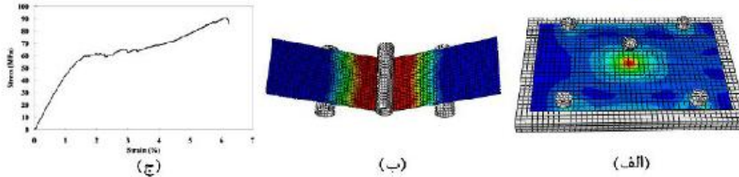
شکل (۲): الف) شبیه‌سازی فرآیند ضربه، ب) شبیه‌سازی فرآیند خمش، ج) نمودار تنش کرنش کامپوزیت بررسی شده
