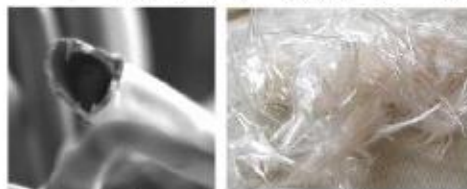
شکل (۱): (آ) الیاف استبرق، (ب) ساختار توخالی لیف استبرق
