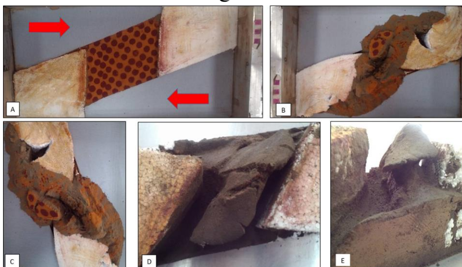
شکل (۸): مراحل مختلف آزمایش دوم. برای مشخص شدن توپوگرافی سطح نمک نفوذ یافته لایه‌های ماسه برداشته شده است.
