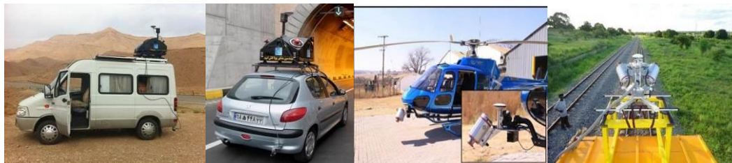
شکل ۳: سکویهای حرکت مختلف برای سامانه StreetMapper
