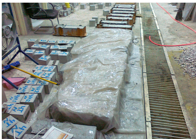
شکل ۵- عمل آوری نمونه‌ها با گونی مرطوب و نایلون
