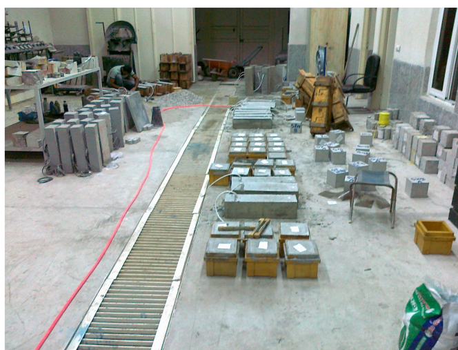
شکل ۶- عمل آوری نمونه‌ها در شرایط نامناسب
