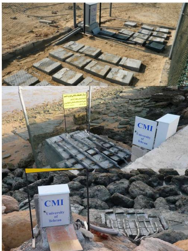
شکل ۱۷- به ترتیب از بالا به پایین: نواحی اتمسفر و خاک، پاشش، جزر و مد
