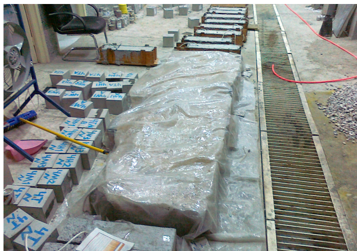
شکل ۵- نگه‌داری نمونه‌ها با گونی مرطوب و نایلون
