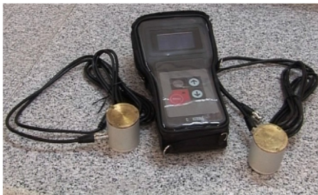
شکل ۲- دستگاه اندازه گیری سرعت امواج آلتراسونیک
