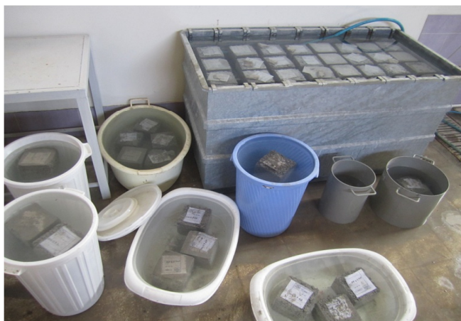
شکل ۱- نمونه های بتنی در حوضچه آب سرد
