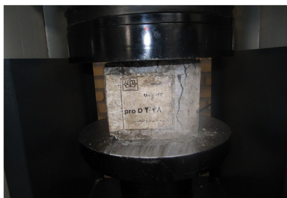
شکل ۳- دستگاه اندازه گیری مقاومت فشاری بتن
